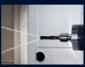
SPINDLE-THROUGH COOLANT SPRAY
