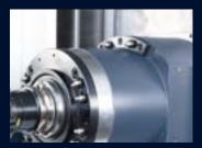
COOLANT SPRAY GUN ON THE SPINDLE HEAD
